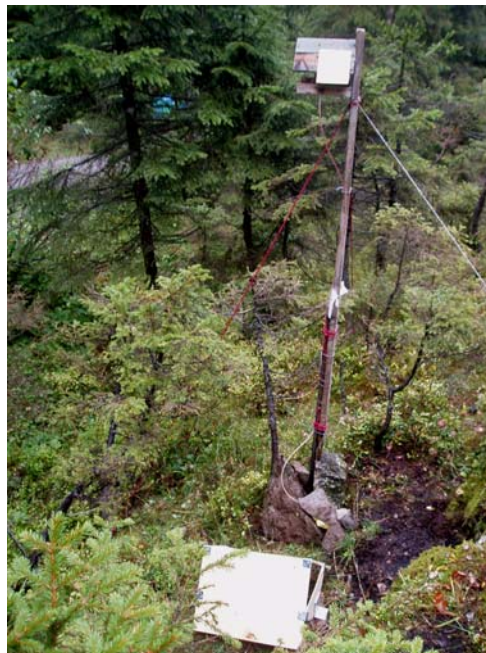
Abbildung 8: Die „Messstation“ im Gelände. Das hintere Messhäuschen wurde an einer Metallstange befestigt und durch Schnüre gegen den Wind gewappnet.
