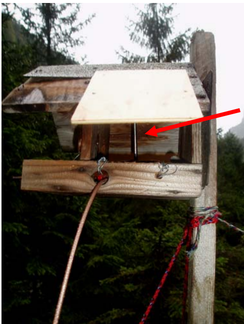
Abbildung 7: Wetterschutzhäuschen mit dem Lufttemperaturfühler im Innern (roter Pfeil)
