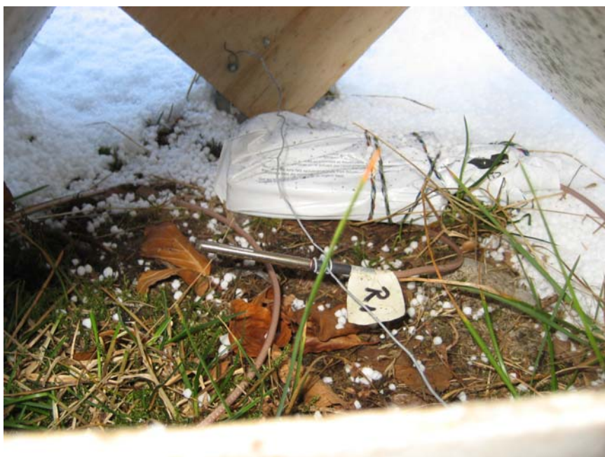
Abbildung 15: (3. November 2006) Blick ins innere des Häuschens, unter dessen Dach die Temperatur 5 cm über Boden gemessen wurde: Im Zentrum ist der Messfühler zu sehen, der mit dem dick in Plastik eingewickelten Datalogger verbunden ist (Hintergrund). Die Konstruktion scheint ihre Schutzfunktion gut erfüllt zu haben, da kaum Schnee eingedrungen ist.
