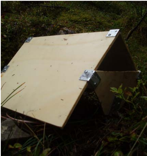
Abbildung 6: Wetterschutzdach zur Messung der Temperatur 5 cm über dem Boden
